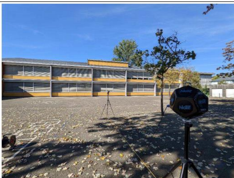
Photographie illustrant les mesures de décroissances linéaires
