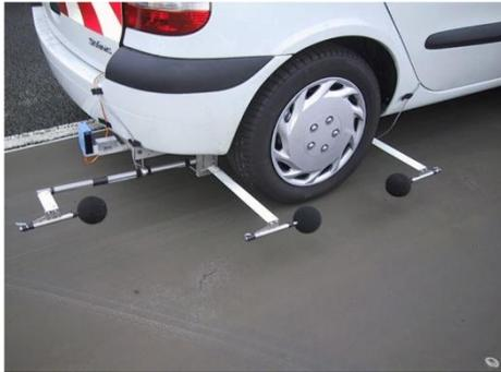
**SONORROUTE :** Mesure en continu du bruit de contact pneumatique-chaussée.
