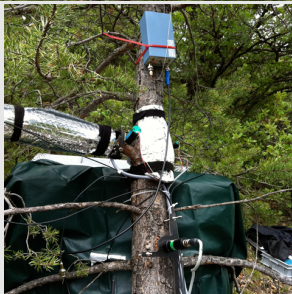
Pin équipé de capteurs écophysiologique et à ultrasons [a].
