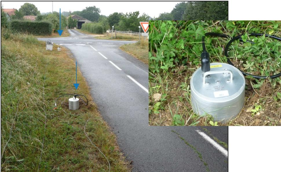
•Mesures réalisées selon la norme NFISO 14837-1 5 (3 capteurs par site)
