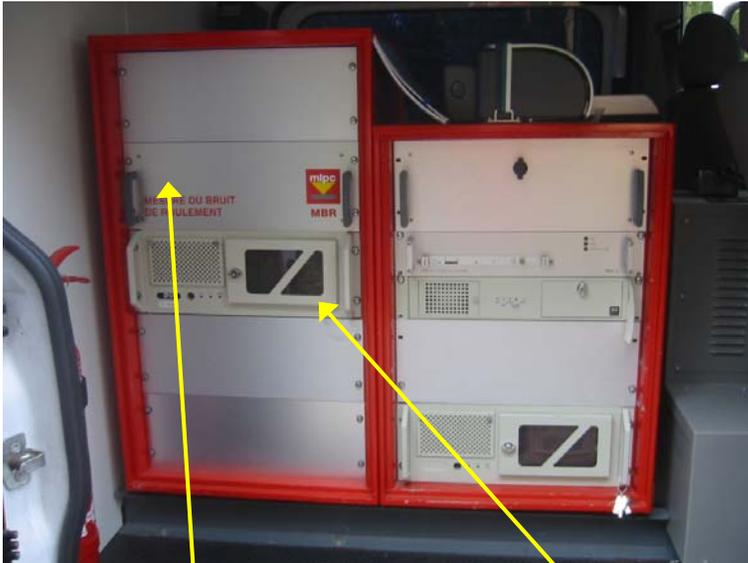
Armoire « APO » avec superviseur et boîtier « MBR » pour la mesure acoustique
